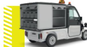
Caisson avec volets roulant latéraux et arrière
